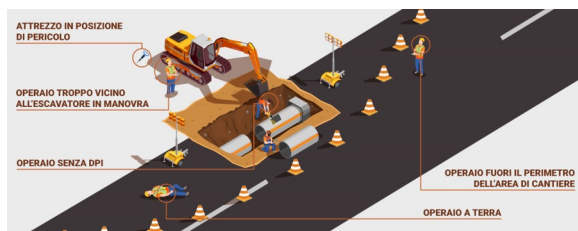
Figura 1: Scenario di cantiere stradale mobile, con evidenziati i casi d'uso affrontati nel progetto SAFER.
