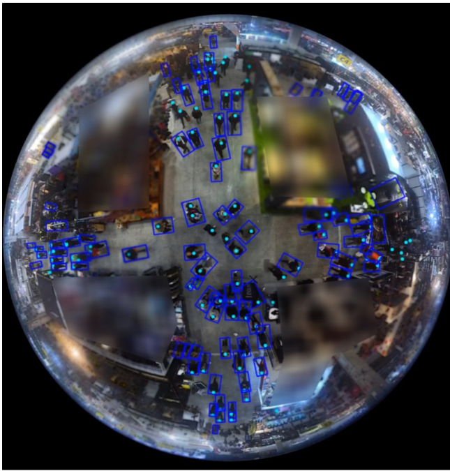
Figura 2: una telecamera fisheye operante nei quartieri di Veronafiere, con sovrapposta una grafica che mostra il sistema di conteggio delle persone eseguito da HS.Vision.
